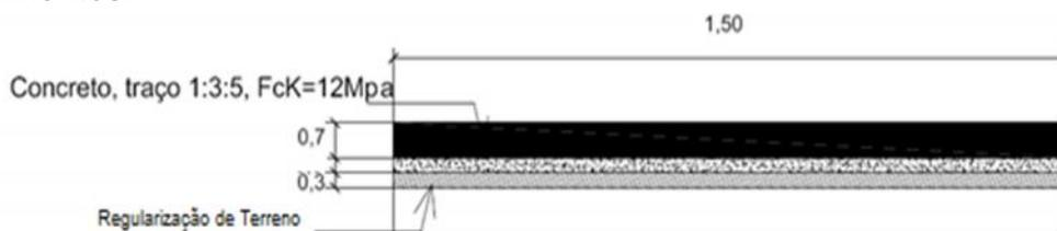
Figura 1 – Componentes da estrutura do passeio.
