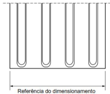
**Figura 6 – Referência de dimensionamento do piso tátil direcional**
