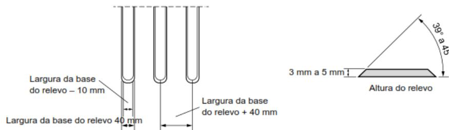
**Figura 7 – Relevos táteis direcionais instalados diretamente no piso**
