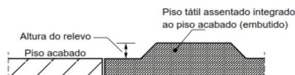
**Figura 75 – Detalhe do piso tátil integrado ao piso**
