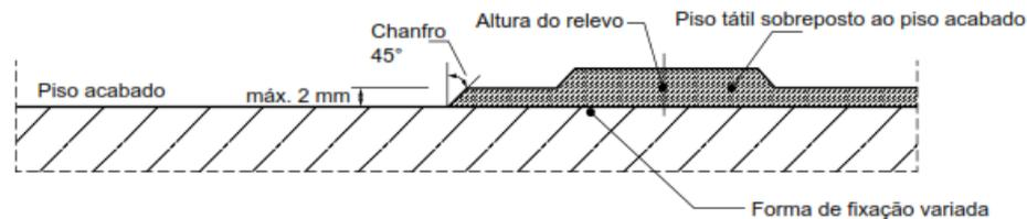
Esta figura é indicativa da posição do piso tátil em relação à superfície do piso acabado, cuja forma de fixação deve proporcionar resistência de arrancamento.
