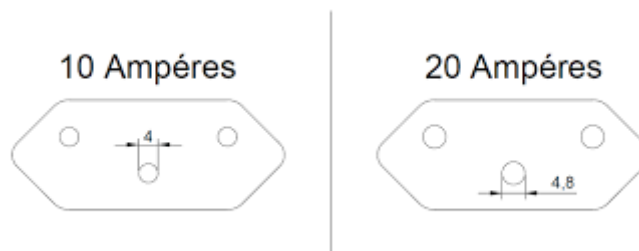
Figura 3 - Dimensão do plug das tomadas de 10A e 20A
